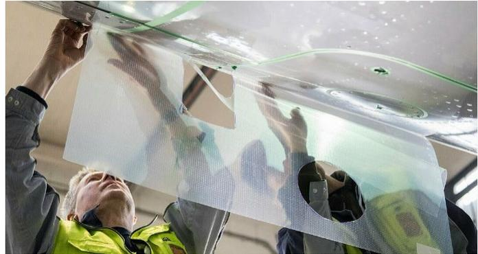
Ziel der Maßnahme in der UAG QuickWins ist die Ausweitung des AeroSHARK STC auf weitere Bereiche des Flugzeuges, wie Tragflächen und Leitwerke, was Einsparungen von bis zu 3% verspricht. Darüber hinaus die Applikation auf weiteren Langstreckenmustern wie dem Airbus A330 (Vollständige Beklebung).
